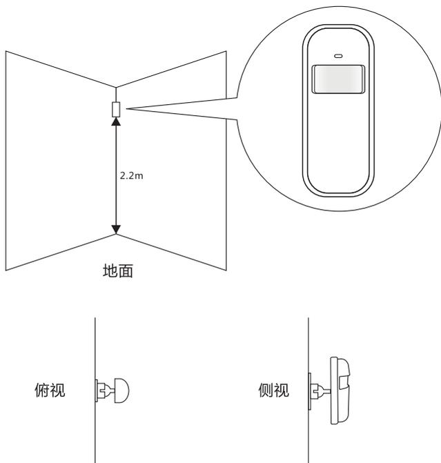
把探测器固定在安装支架上，通过调整安装高度或调节支架来改变探测角度与距离。建议安装高度离地面2.2米。
