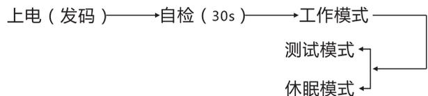
**测试模式：**在测试模式下，探测器每2.5秒探测一次，当检测到人体信号时立即发出无线报警信号，可有效避免漏报。在此状态下用户亦可连续测试探测器的探测角度以及探测距离，以此判断探测器安装的位置及高度是否合理。
